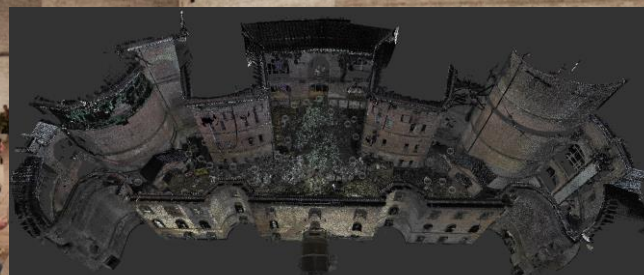
Ортофотоплан (облако точек) после лазерного сканирования
