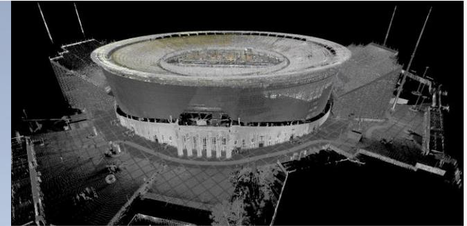
Ортофотоплан (облако точек) после лазерного сканирования
