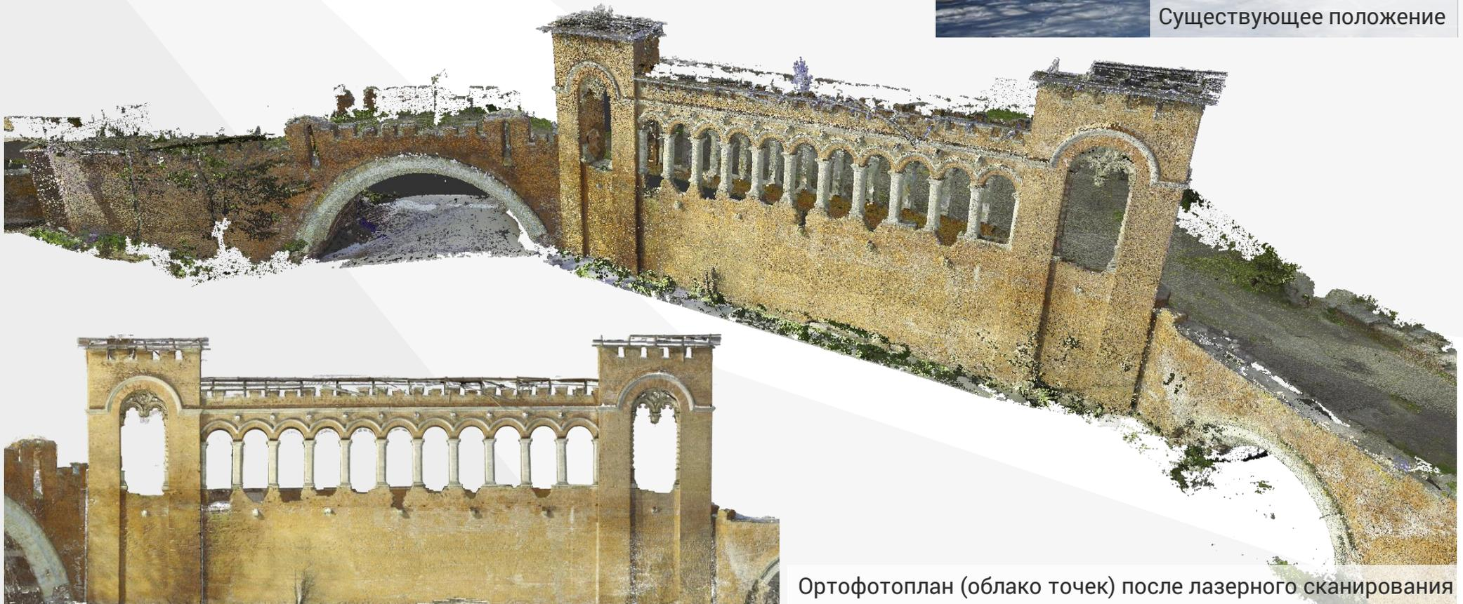
Ортофотоплан (облако точек) после лазерного сканирования
