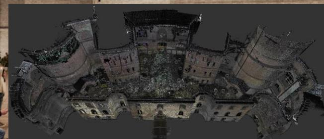
Ортофотоплан (облако точек) после лазерного сканирования
